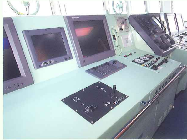
ジョイスティック操船装置 / JOY STICK control system
