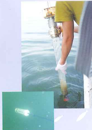
コアサンプラーによる海底土の採取 Bottom sediment sampling by piston core sampler
