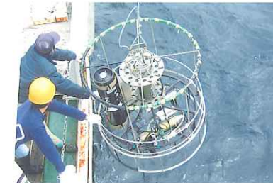
オクトパスシステムによる海洋観測 Observation of physical, biological and optical oceanographic parameters by octopus system CTD equipped
